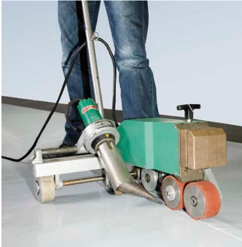
Bild 2. Heißluftschweißen ohne offene Flamme
