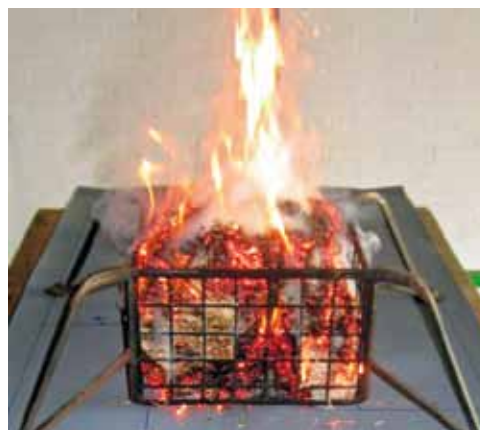
Abb. 4: Brandprüfung nach DIN CEN/TS 1187
